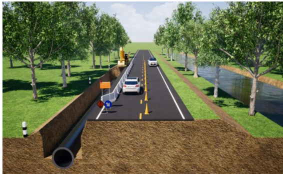
ดำเนินการขุดวางท่อ โดยให้การจราจรของรถยนต์ ผ่านทางเบี่ยง พร้อมติดตั้งป้ายและสัญญาณไฟเตือน
